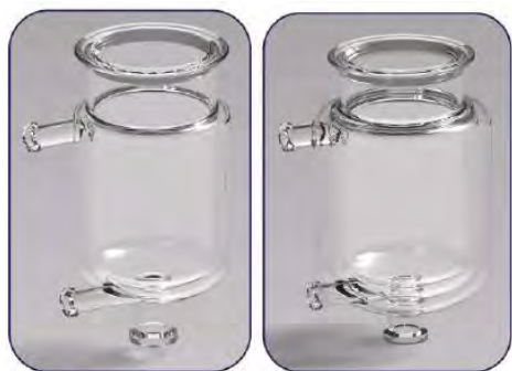
Взаимозаменяемые сосуды DN100 (главный фланец с проходным диаметром 100 мм)
