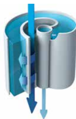
Рисунок 1. Сквозной вид ОО мембраны системы RiOs™ Essential, вставленной в картридж. Тангенциальное направление потока снижает риск засорения мембраны; мембрана удаляет 95-99% неорганических и 99% всех растворенных органических веществ молекулярным весом более 200 Дальтон, таких как микроорганизмы и частицы.
