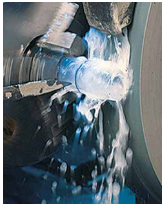
NS-Kerne werden auf halbautomatischen Rundschleifmaschinen weiterbearbeitet.
