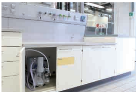
Лаборатория с компактной подачей вакуума. Удобное управление насосом с интегрированным CVC 3000E.
