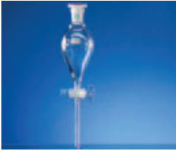
SCHEIDETRICHTER; KONISCHE FORM DIN 12 451, ISO 4800 graduierter Hahn mit massivem Glasküken
