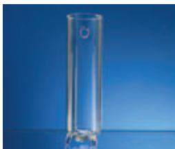
EXTRAKTIONSHÜLSE mit Löchern im Boden
