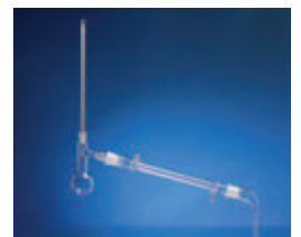
APPARATUR ZUR BESTIMMUNG DES DESTILLATIONSBEREICHES nach DAB (10. Auflage) bestehend aus Destillierkolben, Thermometer, Liebigkühler und Destilliervorstoß
