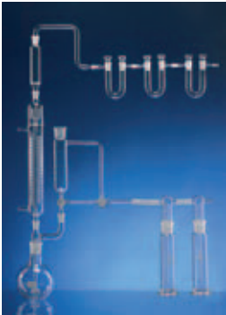
BESTIMMUNG DER SUMME DES GELÖSTEN KOHLEN-DIOXIDS (G 1) DIN 38 408 Teil 1 (DEV) bestehend aus Stehkolben, Gaswaschflaschen, Tropftrichter, Gaswaschglocke, Trockenrohre, Schlangenkühler, Gaseinleitungsrohr, Absorptionsgefäß, Gravimetrisches Verfahren
