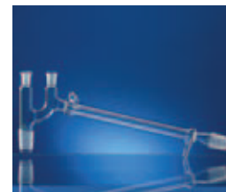
DESTILLIERBRÜCKEN NACH CLAISEN Aufsatz mit zwei NS-Hülse und NS-Kern, Liebig-Kühler mit NS-Kern am seitlichen Ablaufrohr
