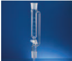
TROPFTRICHTER DIN 12 567, ISO 4800 Hahn mit massivem Glas- küken zylindrische Form, mit Druckausgleichsrohr, mit eingeschmolzener Tropfspitze, Hahnküken mit Gewinde und Schraubsicherung graduert
