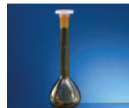
MESSKOLBEN BRAUN-GLAS DIN 12 664 mit NS-Polypropylen Stopfen Klasse A, konformitätsbescheinigt
