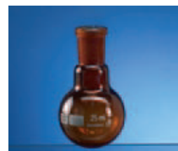
MITTELHALS-RUND- KOLBEN DIN 12348 Braunglas Hals mit NS-Hülse
