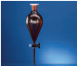
SCHEIDETRICHTER; KONISCHE FORM DIN 12 451, ISO 4800 braun eingefärbt Hahn mit massivem Glasküken
