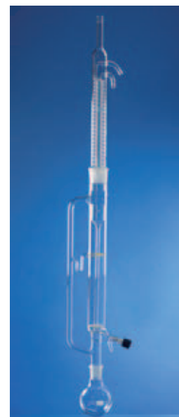
EXTRAKTIONSPARATE zur Extraktion aus Flüssigkeiten für spezifisch leichte Extraktionsmittel, bestehend aus Rundkolben, Extraktionsaufsatz, Extraktionsfilter, Dimrothkühler (ab 500 ml mit Doppelspirale)
