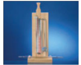
VAKUUMMETER NACH BENNERT auf Holzstativ mit verschiebbarer Skala
