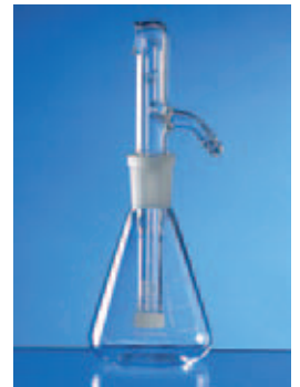
ZERSTÄUBER bestehend aus Erlenmeyer- Kolben und Zerstäuber- Aufsatz
