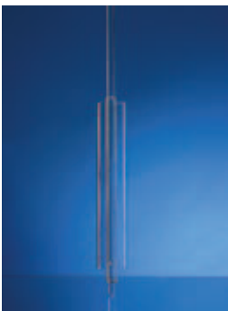
APPARATUR ZUR BESTIMMUNG DER SIEDETEMPERATUR nach DAB (10. Auflage) bestehend aus Siedegefäß und Glasmantel
