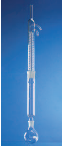
EXTRAKTIONSPARATE zur Extraktion aus Feststoffen (heiß), bestehend aus Rund- kolben, Extraktionsaufsatz, Extraktionshülse mit Löchern im Boden, Dimrothkühler
