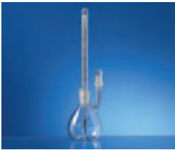
PYCNOMETER NACH GAY LUSSAC DIN 12 797 genau justiert mit eingeschliffenem Thermometer, mit seitlichem Kapillar-Rohr und aufgeschliffener Kappe NS 7/16 DIN 12 809
