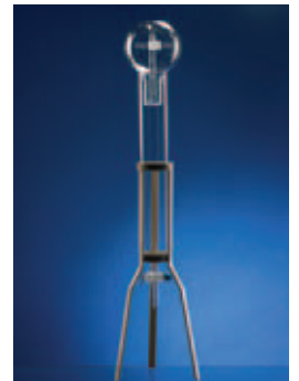
PERKOLATOR nach DAB (10. Auflage) bestehend aus Unterteil mit Hahn, Gestell und Aufsatzkugel
