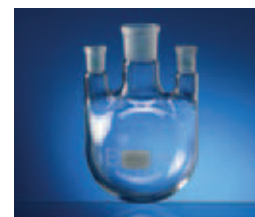
DREIHALS-RUNDKOLBEN DIN 12 392 Mittel- und Seitenhals mit NS-Hülse mit geraden Seitenhälsen
