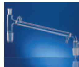
DESTILLIERBRÜCKEN MIT LIEBIG-KÜHLER Aufsatz mit NS-Hülse und NS-Kern, Liebig-Kühler mit angeschmolzenem Vakuum- Vorstoß am senkrechten Ablaufrohr
